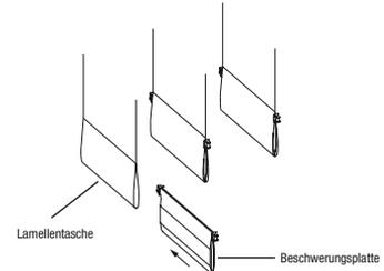
2. Die Kettenclips der Abstandskette auf die vorderen Halter der Beschwerungsplatten aufstecken.
