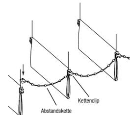
**Wichtig!** Jede Lamelle muss mit einem Kettenclip versehen sein.
