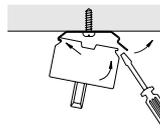
Schiene in die Halter einclippen bzw. mit Schraube festklemmen, je nach Art des Halters.
